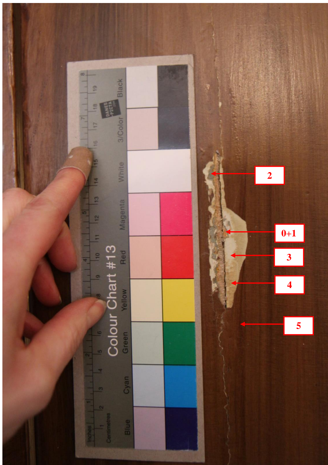
Průzkum barevnosti dveří ve 2. NP: 0 – povrch dřeva, 1 – fragmenty okru, 2 – zelený nátěr, 3 – lomená bílá, 4 – světle okrová, 5 – současný fládr
